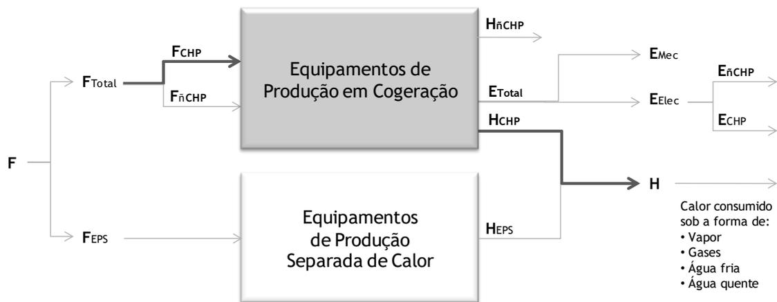
Figura 5 – Representação gráfica de uma Instalação de Cogeração com equipamentos de produção em cogeração (processo ou unidade de cogeração) e equipamentos de produção separada de calor e identificação das principais variáveis objeto de medição.
