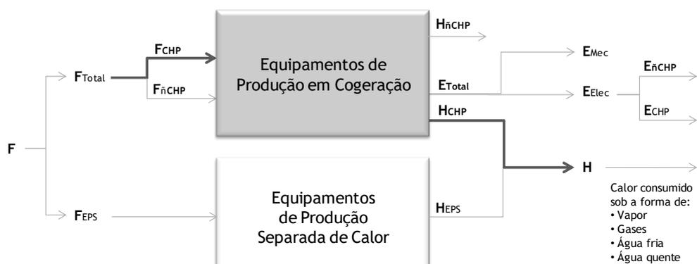
Figura 6 - Representação gráfica de uma Instalação de Produção de energia para aquecimento e arrefecimento e identificação das principais variáveis objeto de medição.
